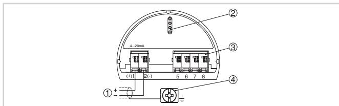
Отсек электроники и подключения (однокамерный корпус)
